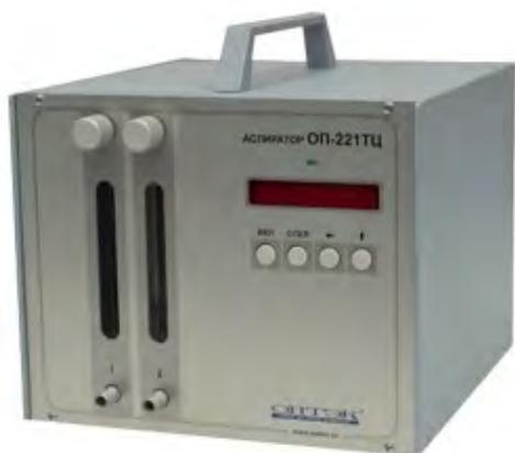
Аспиратор позволяет отбирать пробу заданного объема, рассчитываемого по установленным значениям расхода и времени прокачки.
