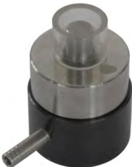
Пресс-форма ПФ13 предназначена для изготовления таблеток диаметром 13 мм.
