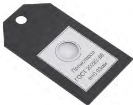
Образцы пленки полистирола входят в комплект поставки спектрометра ФСМ и используются для его поверки.
