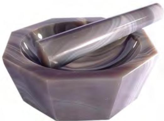
Ступка с пестиком предназначена для измельчения твердых образцов с кристаллами бромида калия для последующего прессования из этой смеси таблеток, а также для измельчения образца при приготовлении суспензии в вазелиновом масле.
