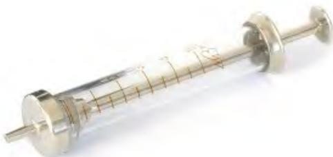
Используется для заполнения жидкостных кювет, позволяет аккуратно влить жидкость через отверстия, избегая протечек и образования пузырей.
